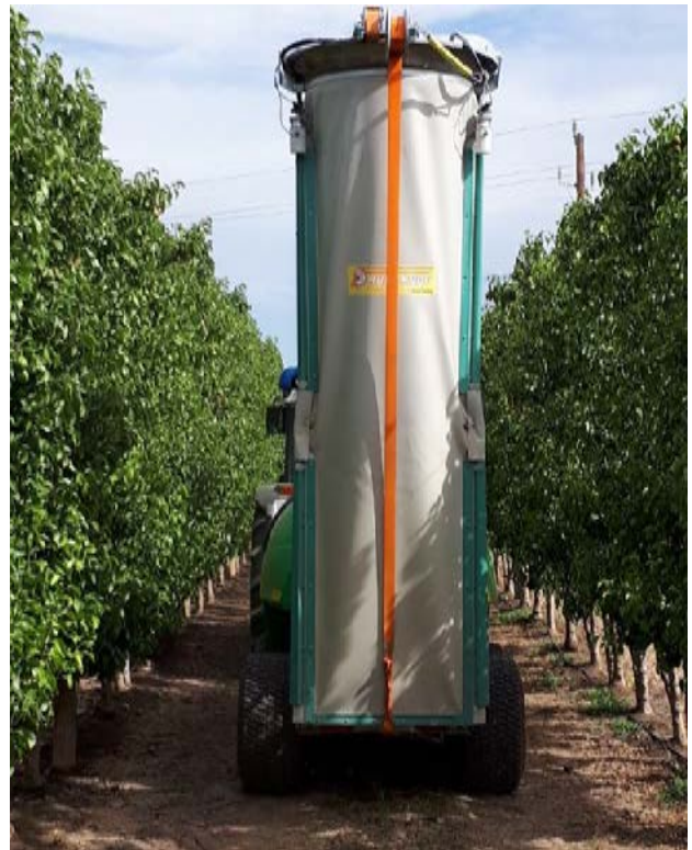
Fig 3. Polvoritzador de flux tangencial Munckhof Varimas (Mollerussa, 16 de juny de 2019)
