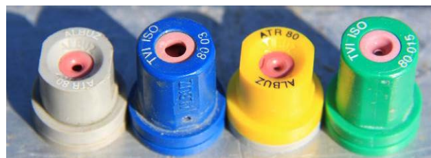
Fig. 7. Broquets convencionals (ALBUZ ATR) i broquets de reducció de la deriva (ALBUZ TVI) assajats.
