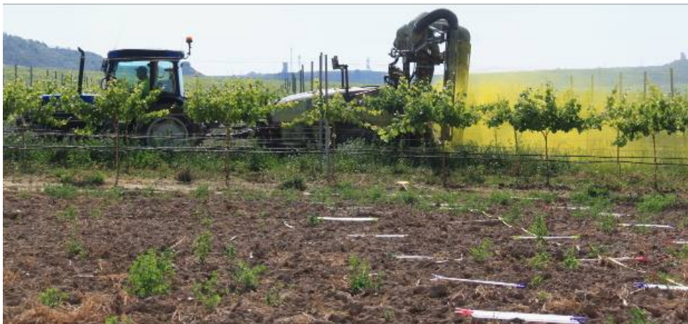
Fig.5. Mesura de la deriva sedimentada (ISO 22866:2005) aplicant traçador (colorant alimentari E102 Tartrazina) i col·lectors situats a la superfície del sòl (Raïmat, 24 de maig de 2019).
