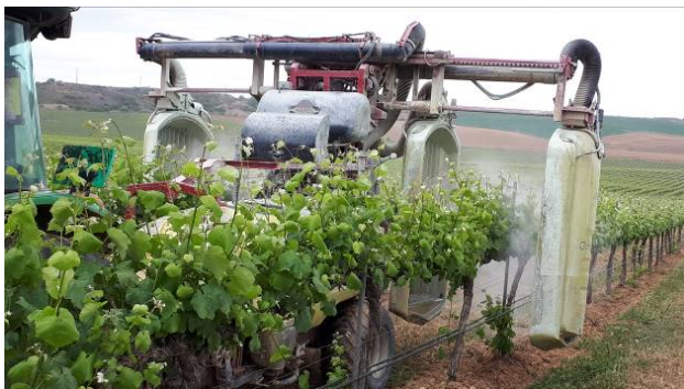
Fig. 4. Túnel de recuperació tractant en fase inicial (Raïmat, 8 de maig de 2019)
